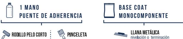
Es aconsejable aplicar previamente una mano de Puente de Adherencia Anclaflex con pincel o con rodillo, para mejorar el anclaje. Dejar secar y aplicar Base Coat Anclaflex Monocomponente con llana metálica para nivelar superficies mal terminadas o para utilizarlo como revestimiento.
